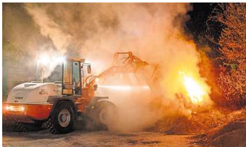
Der Bagger verteilt den Quarzsand überm Container, um das Feuer zu erstickern.
